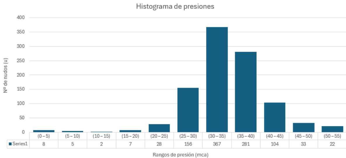
Figura 5. Histograma de los resultados obtenidos para el análisis de presiones del Escenario 1.
