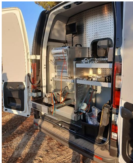
Figura 11. Vehículo robotizado con cámara de inspección integrada.
