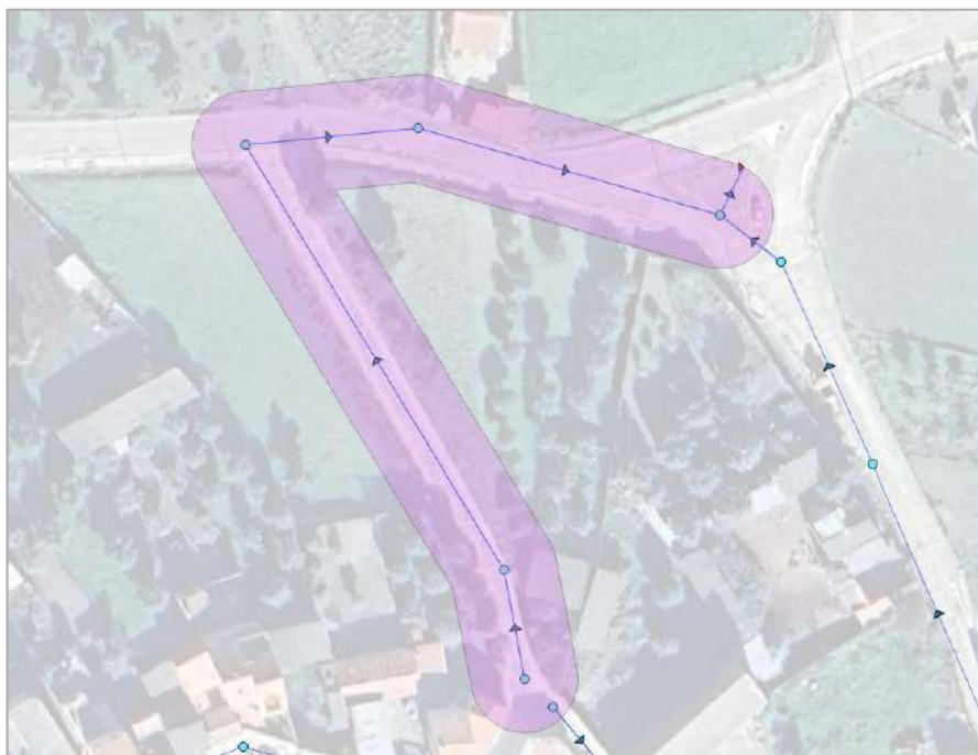
Imagen 5. Ejemplo de dwfzone. El buffer dibujado alrededor de la canalización representa toda la zona que vierte a uno de los nodos de estudio.
